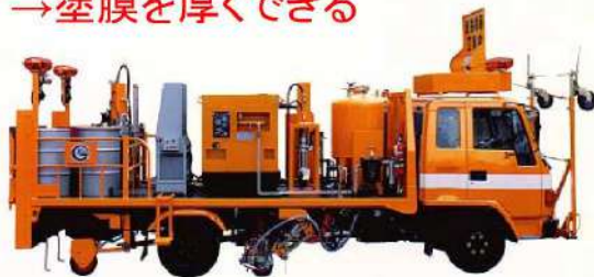
常温式（塗料を加熱しない）も施工可能
