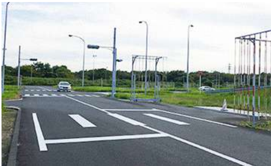
＜図 実験で設置した白線設置間隔 135cm の横断歩道＞
