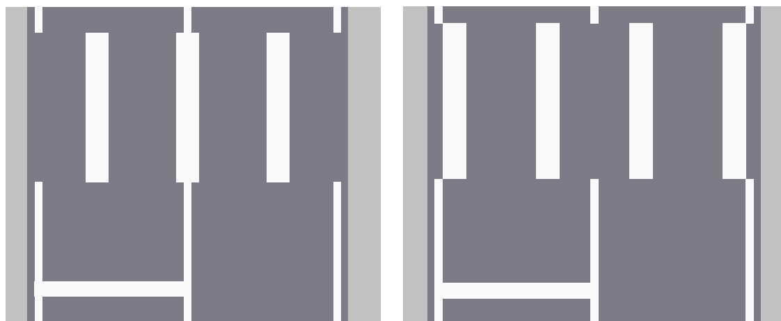
<図 白線設置間隔が135cmで白線3本の横断歩道（左）と白線4本の横断歩道（右）>
